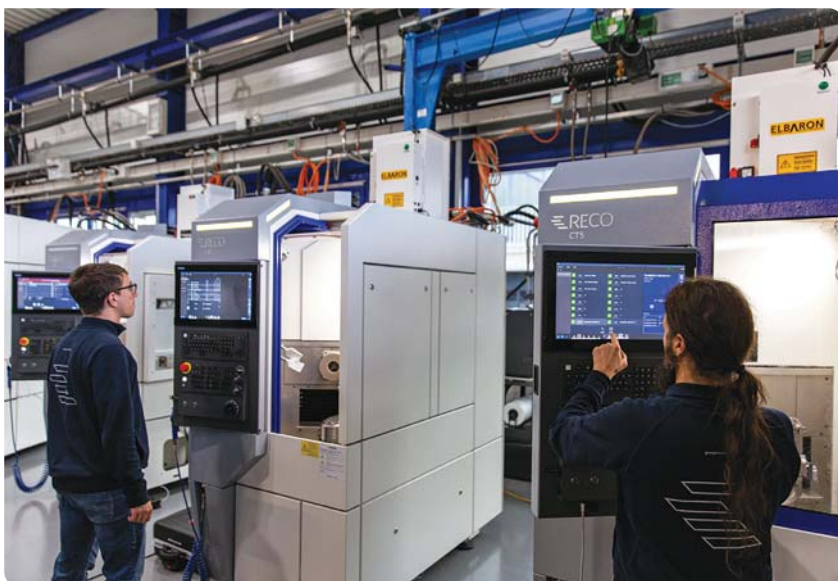
La Reco-CT5 est une machine CNC multifonction à 5 axes simultanés.
